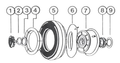
Abdeckkappe (1), Seegerring (2) mittels Seegerzange lösen. Rad von Achse abziehen. Darauf achten, dass Kugellager- Abdeckscheibe (9) sowie evtl. vorhandener Distanzring (3) nicht verloren gehen.
